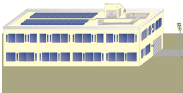
Figura 17: Armazém logístico sem proteção contra a descarga atmosférica
